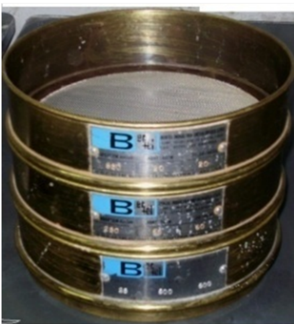
Figura 3. Peneiras de 20, 60 e 400 mesh sobrepostas.
