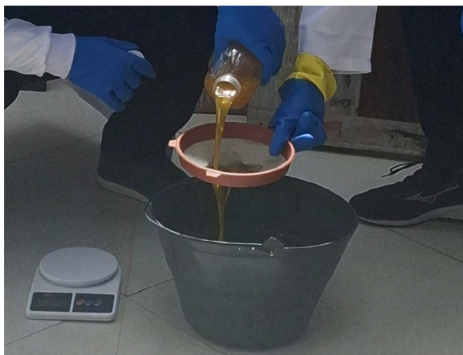
Figura 3. Óleo sendo refiltrado com o auxílio de uma peneira
